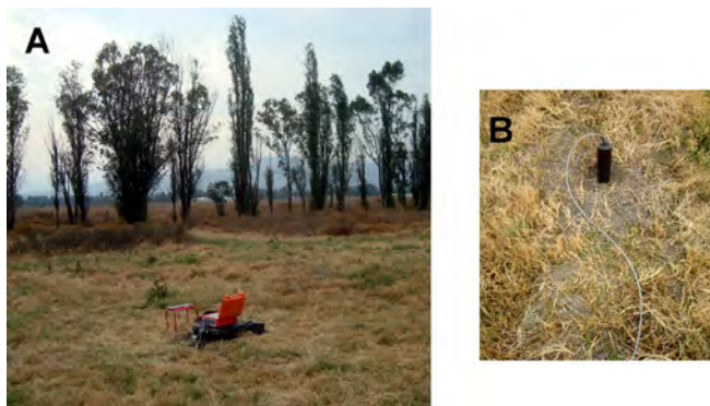
Figura 4 A) Medición de la variación del campo eléctrico y magnético para el sondeo magnetotelúrico (MT) usando el equipo ADU-07e (Metronix GmbH). B) Bobina de inducción de banda ancha para la medición del componente vertical del campo magnético.
