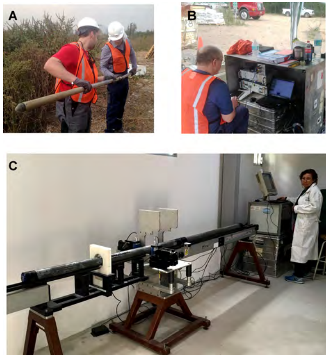
Figura 6 A) Sensor para registrar las variaciones de susceptibilidad magnética, resistividad eléctrica, espectro de rayos gamma y velocidad de ondas p en el pozo A. B) Estación de registro para medición de los parámetros físicos. C) Equipo Geotek con anillo Bartington MS2C en el que se midió la susceptibilidad magnética en los núcleos recuperados.
